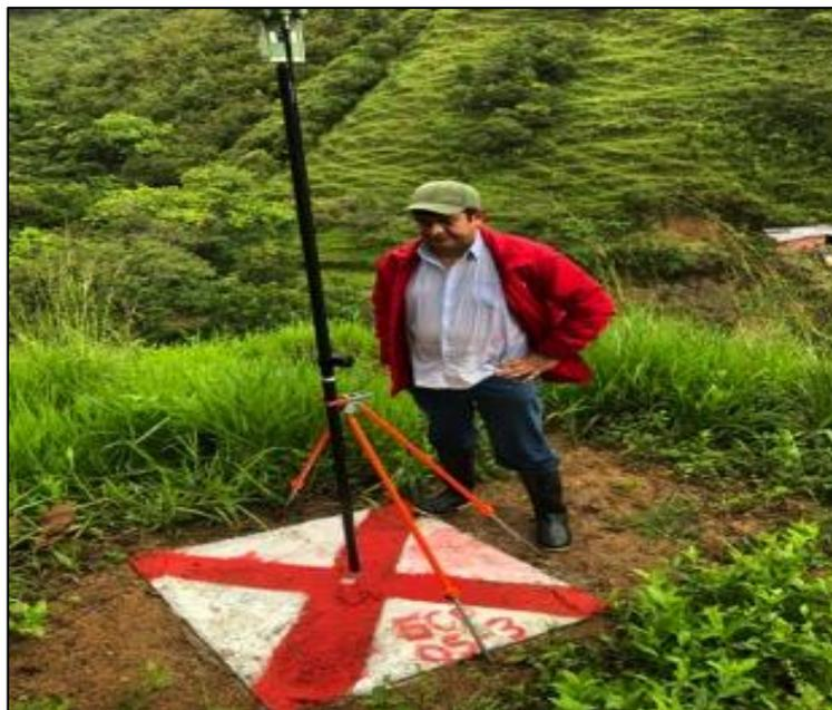
**Ilustración 11. Procedimiento en campo toma de GCP.**
