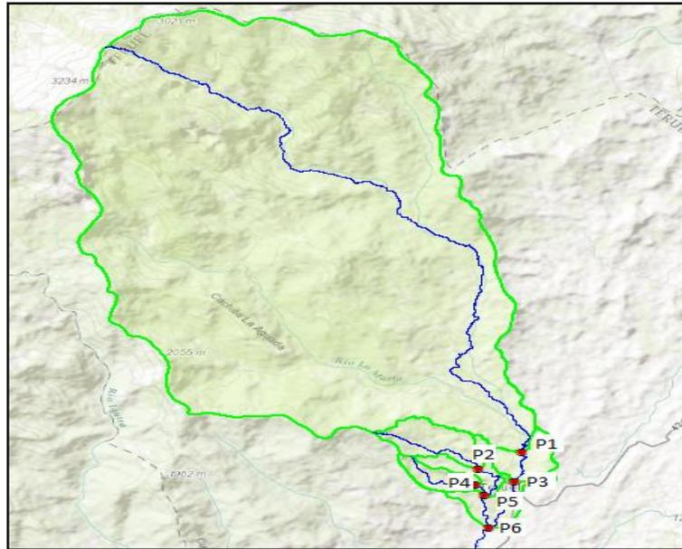
**Ilustración 93. Cuencas de los puntos críticos identificados en el municipio de Teruel.**
