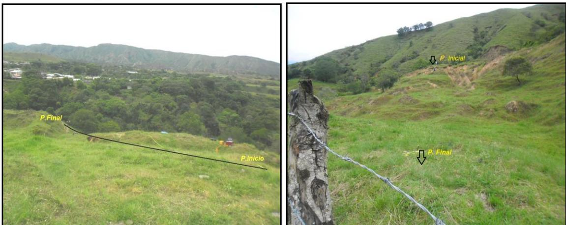
**Ilustración 109. Ubicación del tendido de la línea sísmica LRS-01.**
