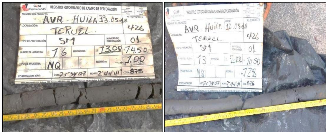
**Ilustración 134. Suelos residuales de la Formación seca, Sr-K2E1s, muestras recuperadas del Sondeo Mecánico SM1, a partir de 8m de profundidad.**
