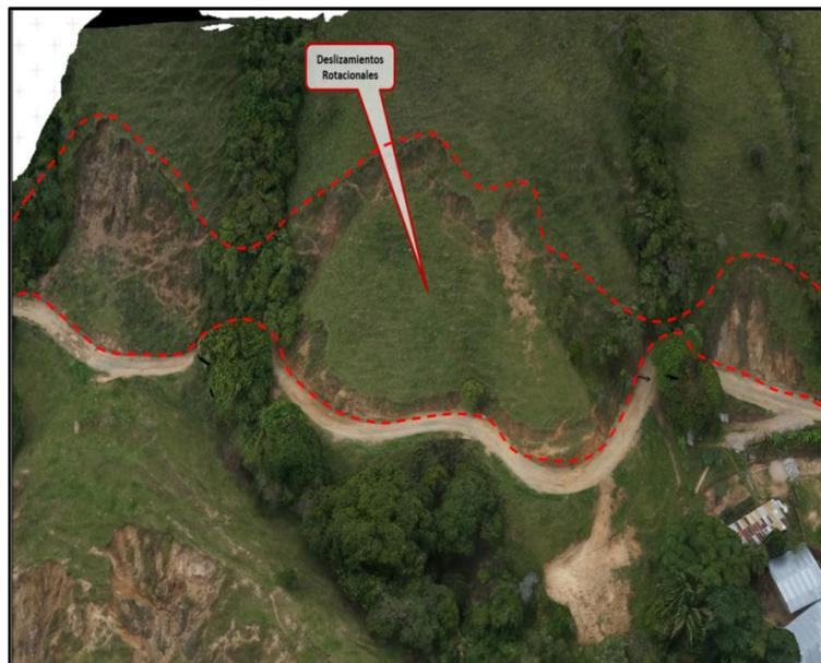
Ilustración 62. Deslizamientos rotacionales en el talud de una vía veredal en el sector suroeste del casco urbano.
