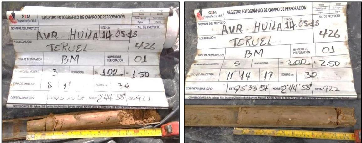
**Ilustración 124. Vista de muestras recuperadas en el BM1 del Suelo Residual Batolito de Ibagué.**
