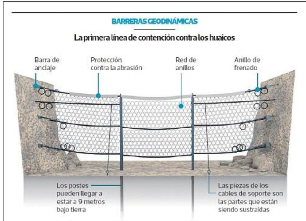
Ilustración 299 Barrera geodinámica.
