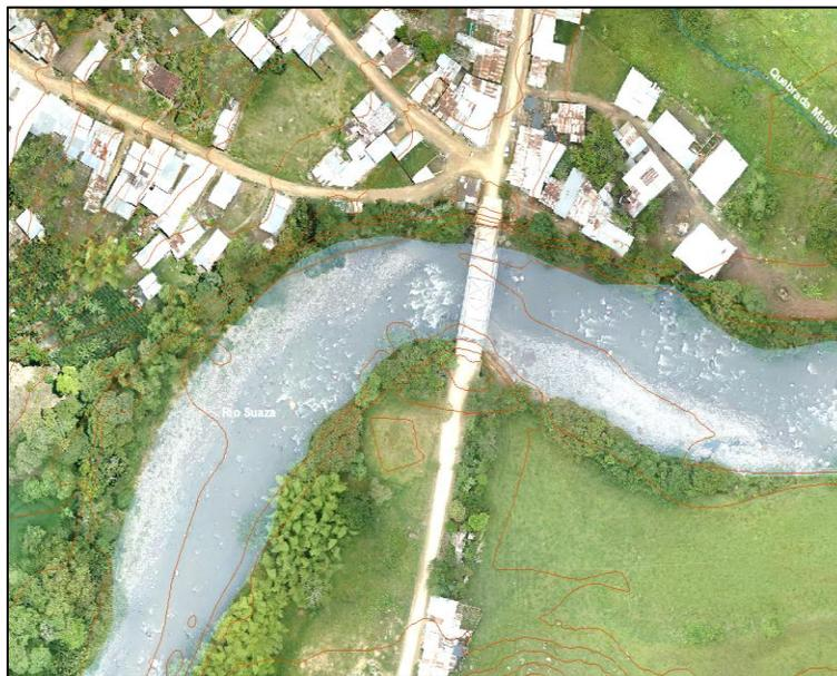
**Ilustración 245. Vista en planta de la curva donde se presenta Socavación por el río Suaza.
