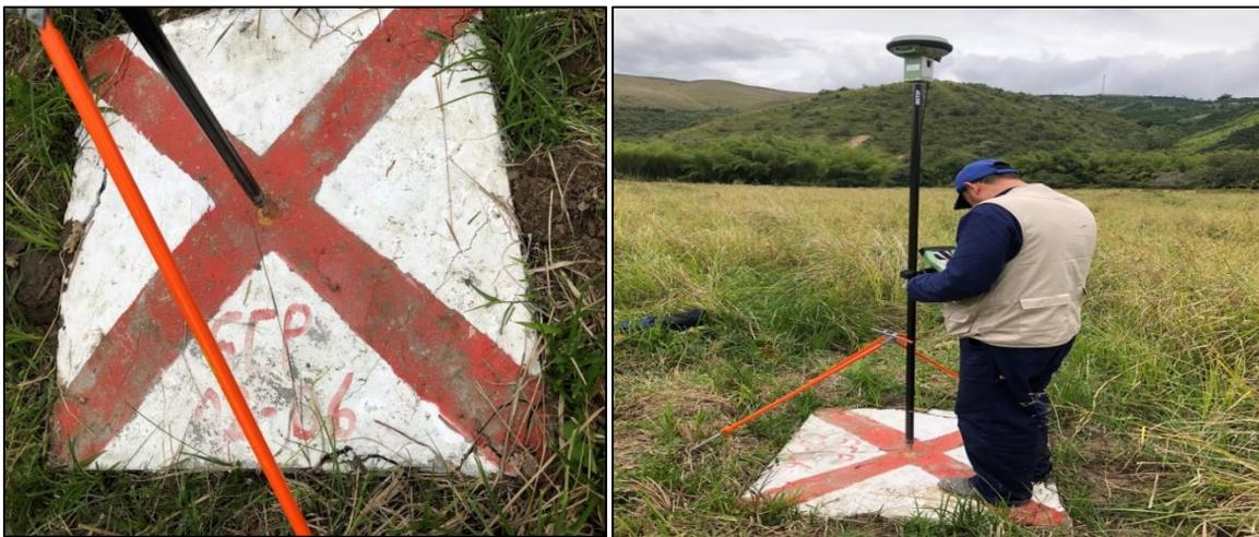
Ilustración 9. Procedimiento en campo toma de GCP.
